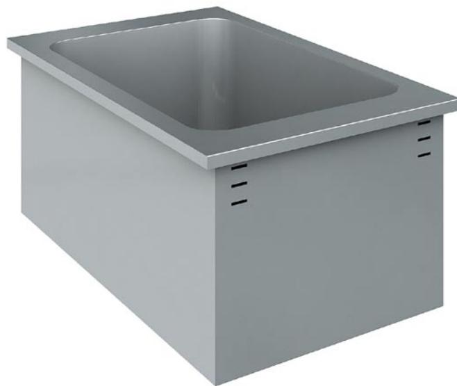
Vasca bagnomaria da incasso, realizzata in acciaio inox AISI 304. Regolazione della temperatura da +30°C ÷ +80°C tramite termostato. Vasca raggiata e stampata, profondità h. 215 mm. Struttura in acciaio inox AISI 304. Mantenimento automatico del livello dell'acqua.
